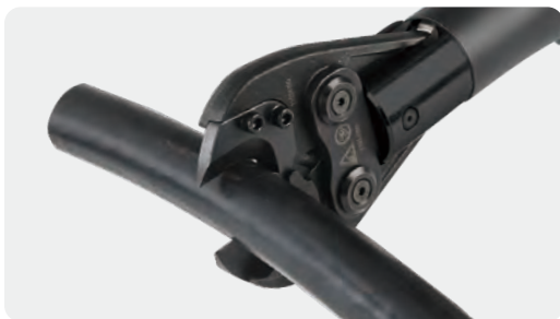
剪切≤φ30mm铜铝电缆 不适用剪切5类(细绞线)和6类(特细绞线)
