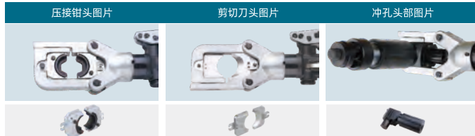
铜压端子：16-300mm 2 铝压端子：10-240mm 2 剪切范围：Φ40mm铜铝线和铜铝铠装线缆 冲孔范围：Φ22.5-Φ61.5mm
